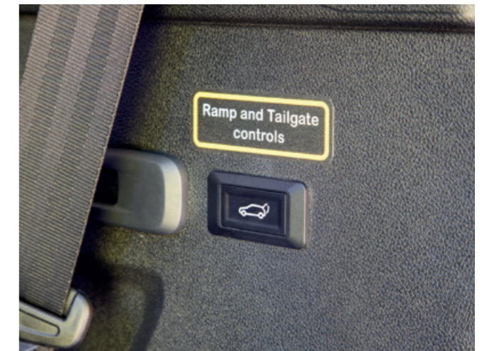
Automatische Öffnung der Heckklappe inklusive Herunterlassen der Rampe per Knopfdruck.
